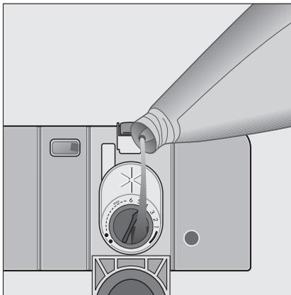
ten Markierung „max“ einfüllen; das entspricht einer Füllmenge von ca.140 ml.
