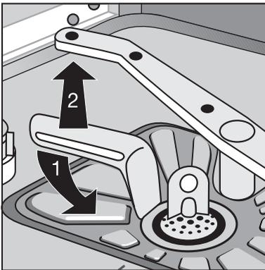
4. Grobsieb (1) an der Grifföse fassen und aus dem Mikrofilter (2) herausziehen.
