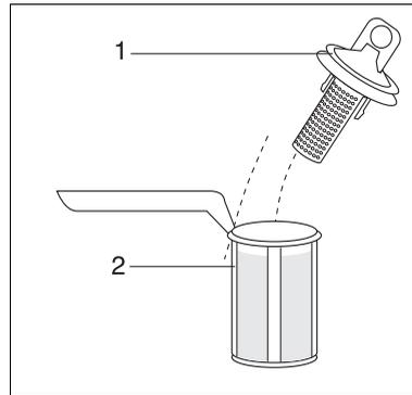
5. Alle Siebe unter fließendem Wasser gründlich reinigen.
